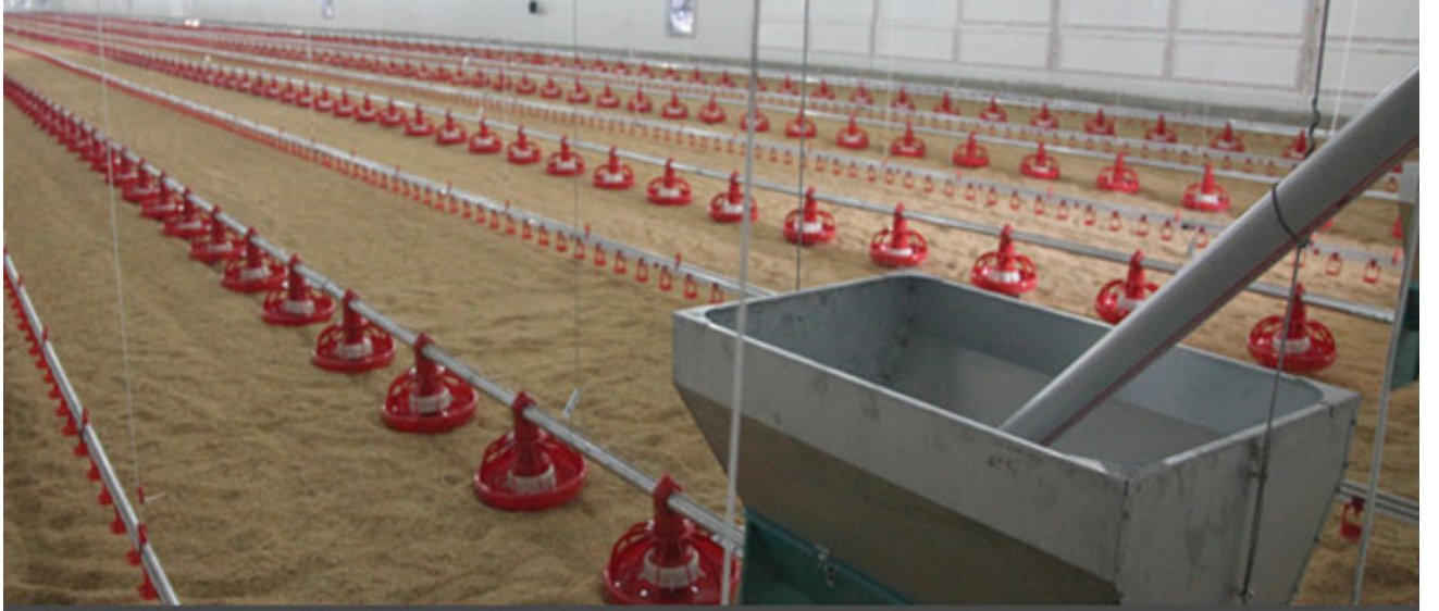
Şekil 12. Kümes içi spiral yemleme sistemi ve elemanları
