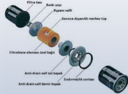
Şekil 9. Spin-on Yağ Filtresinin Kesitleri
