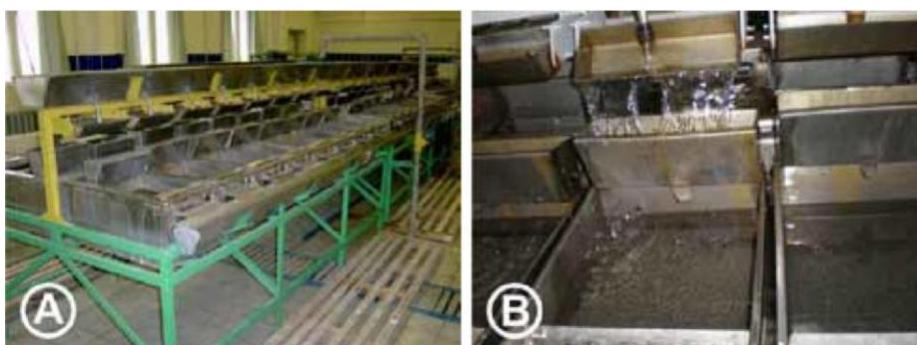
Şekil 46. “Osetr” inkübasyon sistemi: A - sistemin yanıt görünüşü; B – *Huso huso* yumurtalarının inkübasyonu sırasında kuluçka kutuları. (Chebanov ve Galich, 2011)
