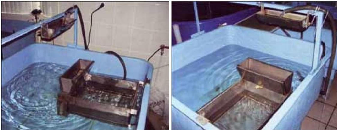
Şekil 47. Modifiye edilmiş “Osetr” tipi inkübasyon sistemi. (Chebanov ve Galich, 2011)
