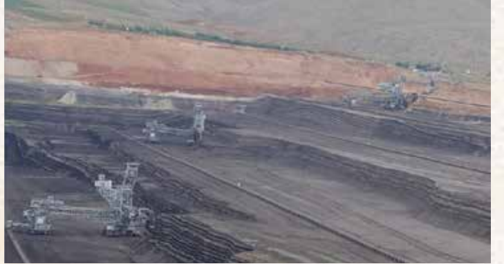
Ek.1. Afşin-Elbistan Termik Santrali sahasının genel görünümü. Gıdya ve leonarditin kazılma aşaması
