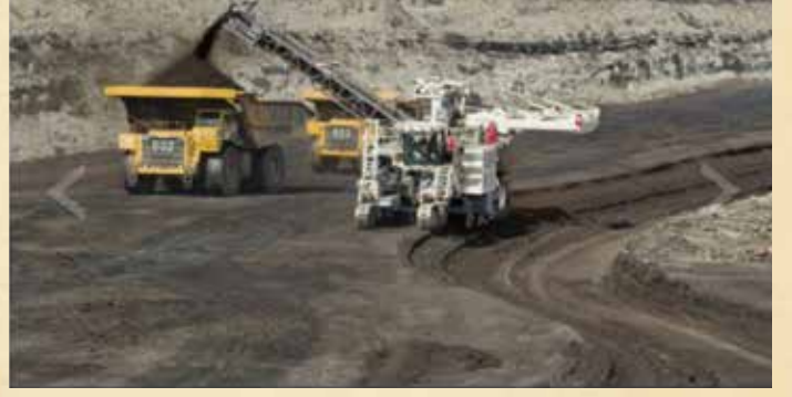
Şekil 3. Gıdya ve leonarditi karıştırmadan kazabilen Yüzey Kazıcı
