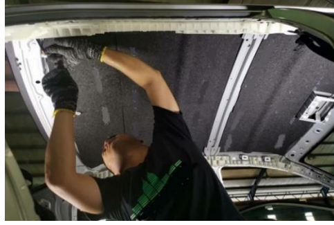
Şekil 9. Tavanda keçe kullanımı
