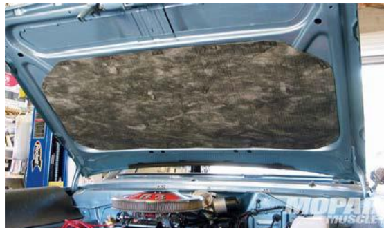
Şekil 17. Motor Kaput Altı Keçe Uygulama Örneği
