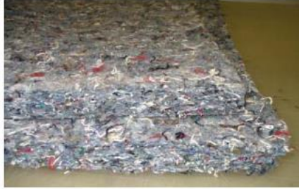
Şekil 15. Koton keçe akustik malzeme örneği
