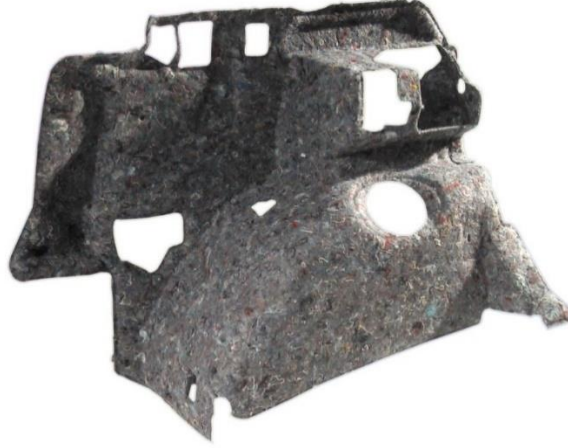
Şekil 24. Otomobilin Tekerlek Bölümünün İçten İzolasyonu İçin Kullanılan Şekillendirilmiş Parça
