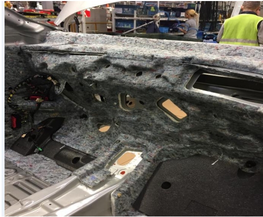
Şekil 16. Ön göğüs ses izolasyonu uygulama örneği
